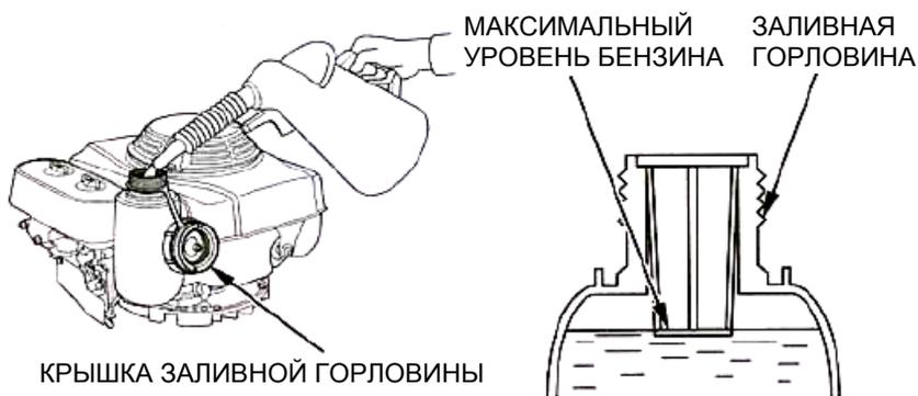
Заливайте бензин осторожно, чтобы не допустить его пролива. Не заполняйте топливный бак до верха. Возможно, потребуется снизить уровень бензина в зависимости от условий работы. После заправки установите крышку топливного бака на место до щелчка.
