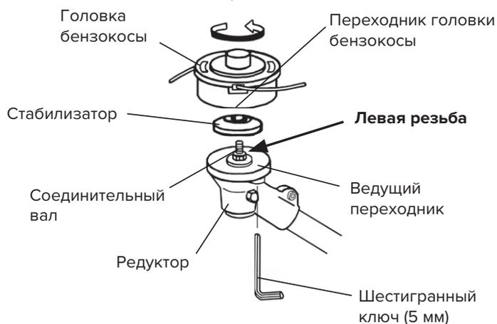
1. Снимите гайку режущего элемента и стабилизатор с соединительного вала и редуктора (сохраните стабилизатор и гайку режущего элемента).
