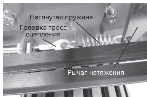
Проверка пружины натяжения
