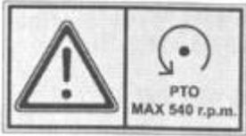
Разрешенная частота вращения вала отбора мощности трактора.
