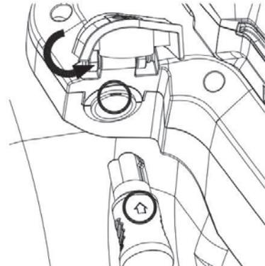
4. Откройте крышку замка, вставьте ключ в указанное на рисунке место до упора, затем закройте крышку замка.
