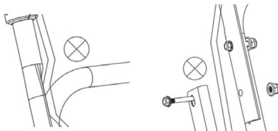
5. Совместите отверстия в нижней рукоятке с отверстиями в защитной крышке и корпусе газонокосилки, затем затяните 2 болта, как показано на рисунке. Можно выбрать два уровня высоты рукоятки, затянув болты в разные отверстия на корпусе газонокосилки.
