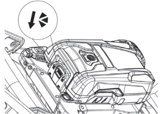
3. Закрепите шнур в держателях, как показано на рисунке. Откройте крышку разъема, совместите стрелку на гнезде со стрелкой на устройстве, затем вставьте гнездо в разъем до упора.
