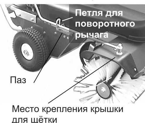
В месте крепления крышки для щётки протолкните конец поворотного рычага к резьбовой цапфе и зафиксируйте с помощью пластмассовой шайбы и стопорной гайки.
