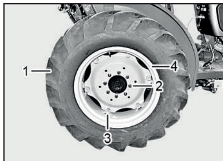
1) Шина (2) Колесная гайка (3) Болт обода колеса (4) Обод колеса
