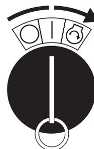
2. Когда двигатель запустится, медленно поверните ручку воздушной заслонки, чтобы двигатель заработал, и держите ее в стандартном положении. Не открывайте ее быстро, когда двигатель холодный или температура окружающей среды низкая, так как двигатель может остановиться. Дайте двигателю прогреться в течение нескольких минут без нагрузки.
