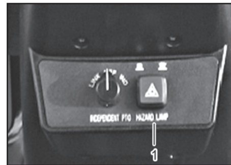
(1) Включатель аварийного сигнала
