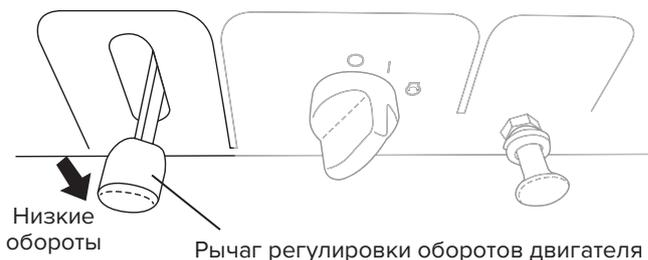
2. После запуска двигателя дайте ему поработать без нагрузки в течение 3 минут, чтобы прогреть его. Прогревая двигатель, также прогрейте гидростатическую трансмиссию (HST).
